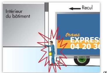
**Ecrasement d'un piéton ou d'un chauffeur dans la zone de manœuvre**
